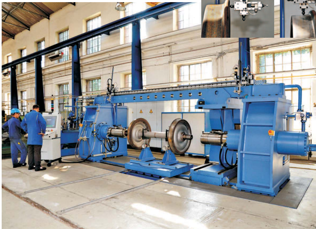
Гідравлічний прес з подвійним гідроциліндром для колісних пар
